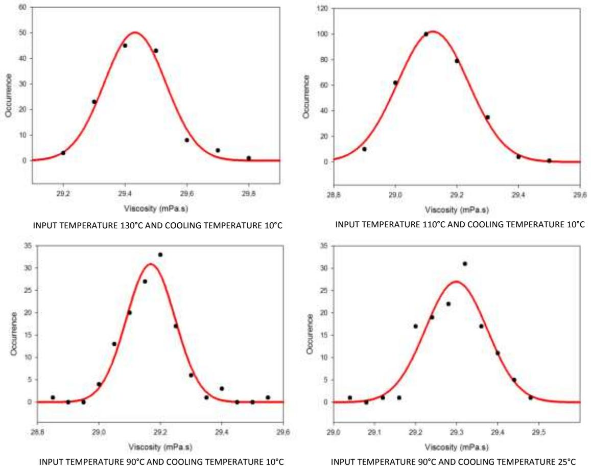
FIGURE 7. DISTRIBUTION OF VISCOSITY VERSUS TIME TESTS
