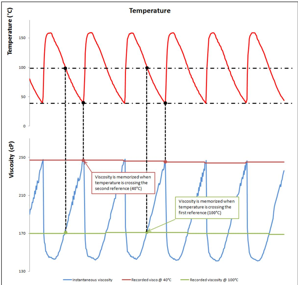
**FIGURE 5. ON-LINE AUTOMATIC VISCOSITY ANALYZER CYCLE RECORDS AT TWO REFERENCE TEMPERATURE**
