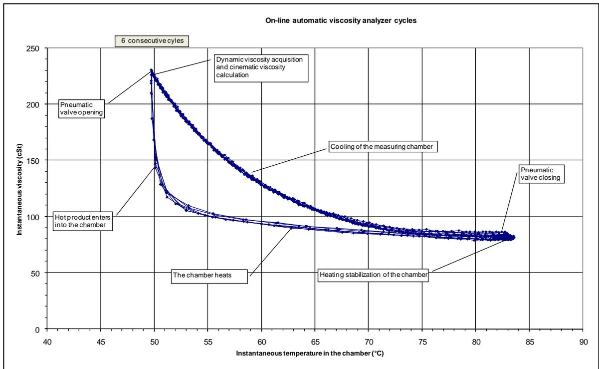
**FIGURE 4. ON-LINE AUTOMATIC VISCOSITY ANALYZER CONSECUTIVE CYCLES**
