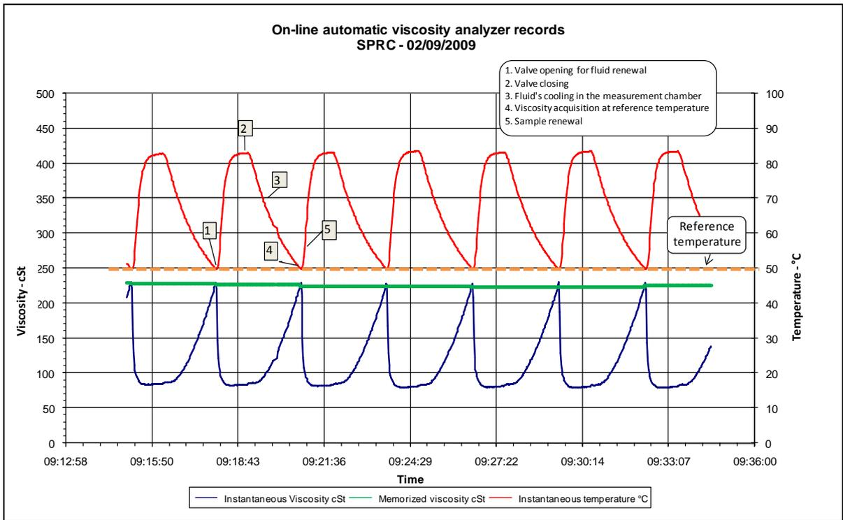
**FIGURE 3. ON-LINE AUTOMATIC VISCOSITY ANALYZER CYCLE RECORDS**
