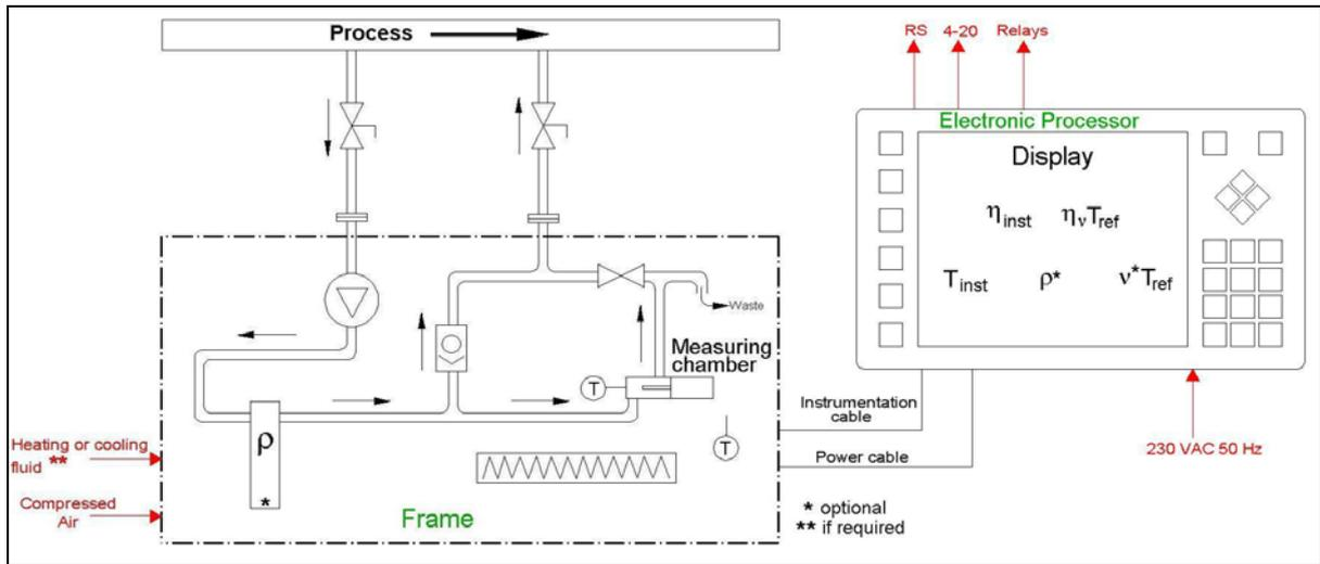
**FIGURE 2. ON-LINE AUTOMATIC VISCOSITY ANALYZER OPERATING PRINCIPLE**
